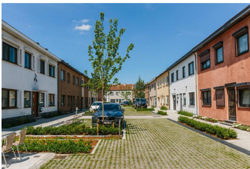
Slika 62. Primjer parkirališta s vodopropusnim materijalom
